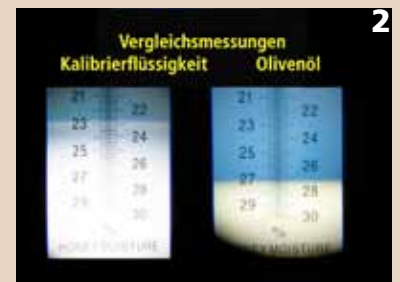
2 Beim Test in der Redaktion zeigte das mit der Kalibrierflüssigkeit eingestellte Refraktometer mit Olivenöl einen beständigen Wert von 27,1 % Wassergehalt an. Fotos: Autor
